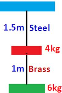
$$\text{ফলে ইস্পাতের তারের দৈর্ঘ্য বৃদ্ধি } \Delta L = \frac{10 \times 9.8 \times 1.5}{3.14 \times (0.125 \times 10^{-2})^2 \times 2 \times 10^{11}} = 1.5 \times 10^{-4} \text{ m}$$
