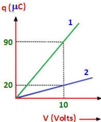
অনুরূপে রেখা (2) এর জন্য  $C_s = \frac{C_1 C_2}{C_1 + C_2} = \frac{20 \times 10^{-6}}{10} = 2 \mu\text{F}$  Or  $C_1 C_2 = 2(C_1 + C_2) = 18 \dots \dots (2)$  এবং আমরা চূড়ান্তভাবে এই দুই সমীকরণ সমাধান করে পাই  $C_1 = 3 \mu\text{F}$  এবং  $C_2 = 6 \mu\text{F}$
